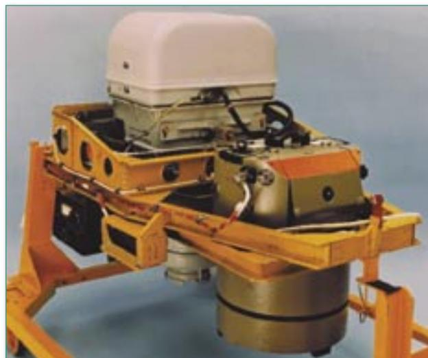
Fig. 1a – Un appareil grand-format de chez Hycon (en fond) et un appareil standard Leica RC 10 fixés sur une monture double – comme lors des vols à haute altitude d'un des ER-2 de la NASA. (Crédit : NASA)
