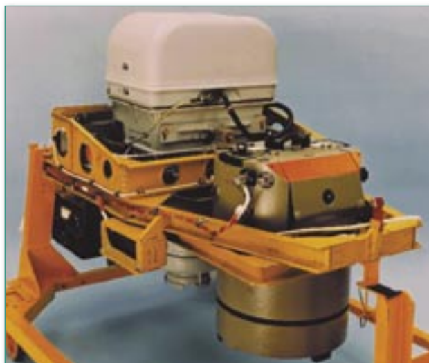
Fig. 1a – Un appareil grand-format de chez Hycon (en fond) et un appareil standard Leica RC 10 fixés sur une monture double – comme lors des vols à haute altitude d'un des ER-2 de la NASA. (Crédit : NASA)
