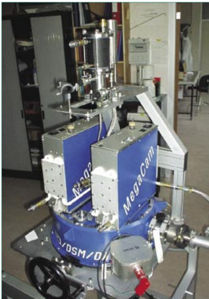
Fig. 5a – La caméra numérique MegaCam montée dans un étui de transport. La caméra est issue des laboratoires du CEA et équipe le télescope Canada-France-Hawaï Telescope (CFHT) situé au sommet du Mauna Kea à Hawaï. (Crédit : CEA)
