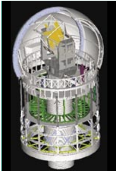
Fig. 7a – Un écorché en perspective du prototype du télescope PS-I avec son primaire de 1,8 m de diamètre. Ce doit être le premier d'une série de quatre instruments formant une partie du futur observatoire Pan-Starrs qui prendra place sur le Mont Haleakala de l'île Maui, à Hawaï.
