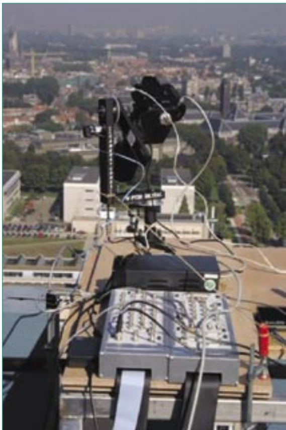
Fig. 2c – Le boîtier Nikon D1x équipé de sa monture motorisée en azimut-élévation et de son électronique de commande, placé sur le parapet de l'immeuble de 100 m de haut du département électronique de l'Université technologique de Delft pour photographier la ville alentour. (Crédit et © TNO)
