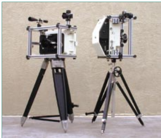
Fig. 1b – Deux versions différentes de la caméra grand-format Fairchild qui ont été modifiées pour être utilisées dans le cadre du projet Gigapxl – le grand côté (43 cm) est horizontal sur l'exemple de gauche, il est vertical sur celui de droite. (Crédit : le projet Gigapxl)
